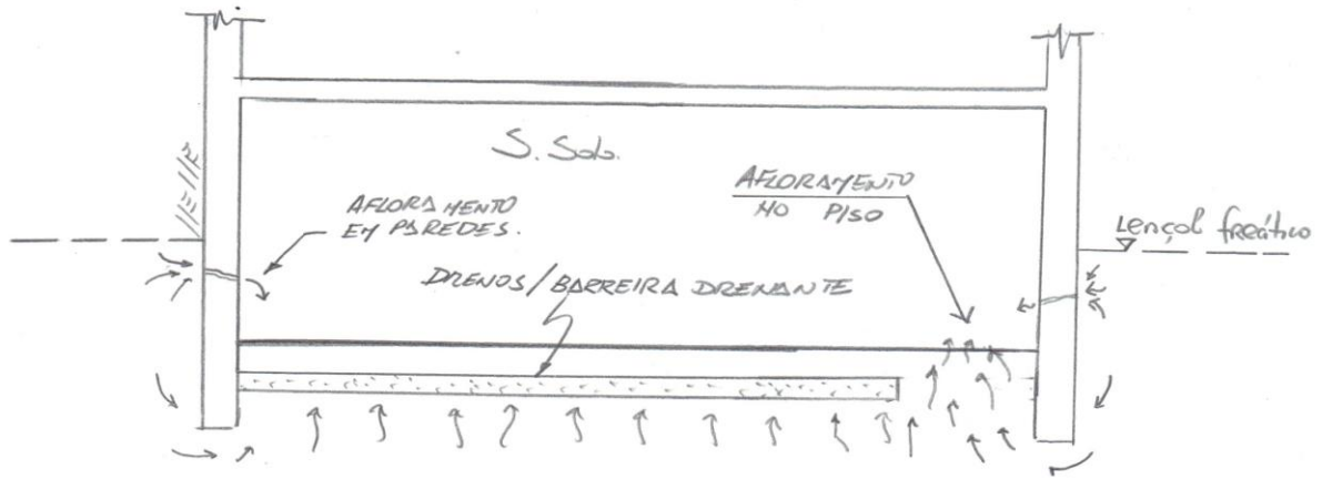
Figura 3 – Esquema típico de afloramento de água em subsolos
